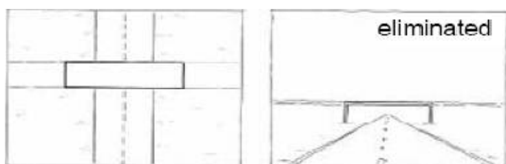
شکل 3-28: ارتفاع نامساوی سازه حذف شده است
