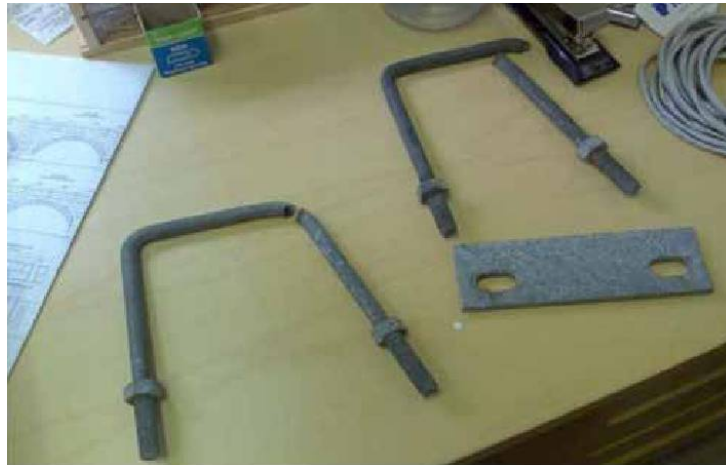
شکل ۲- چفت و بست های شکسته حصار برف گیر
