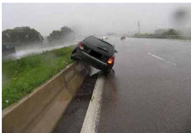
تصادف به دلیل تشکیل لایه نازک آب در سطح راه
